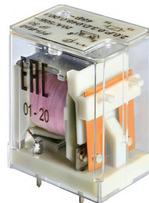
Промежуточное реле РП-Ир2 на одно замыкание, с двойным разрывом цепи, магнитным дугогашением, предназначено для коммутации электрических цепей постоянного тока напряжением до 300 В и переменного тока напряжением до 400 В частотой 50 Гц. Реле РП-Ир2 соответствует техническим условиям ФИМД.640171.001 ТУ.
