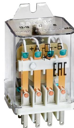
Электромагнитное реле РЭК-59 средней мощности предназначено для коммутации электрических цепей постоянного и переменного тока частотой до 50 Гц. Реле РЭК 59 исполнений от ШРВИ.647115.001 до – 18 с выводами шириной 3,6 мм под пайку, исполнений от ШРВИ.647115.001 – 40 до -66 с выводами шириной 2,8 мм на розетку КС-6 или под соединитель 1-13-Хим.Пас.-У2 ГОСТ 25671 (соединители входят в комплект поставки).
