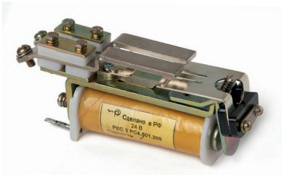
Электромагнитное реле средней мощности постоянного тока РКС 3 на одно замыкание с двойным разрывом цепи и дугогасящими контактами предназначено для коммутации электрических цепей постоянного и переменного тока частотой 50 Гц. Вид климатического исполнения – УХЛ и Т по ГОСТ 15150. Реле РКС 3 соответствует техническим условиям РАО.450.018 ТУ.
